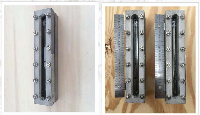
**Questo tipo di indicatore può essere collaudato solo dopo essere diventato parte integrante del serbatoio a cui viene saldato. DIESSE controlla singolarmente i componenti secondo quanto previsto dalle procedure di qualità aziendali e dalle vigenti normative di settore. I relativi certificati vengono emessi su richiesta.**
